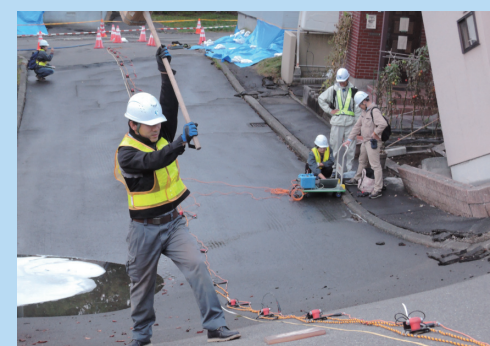
札幌市での表面波探査 人工的な地震を与えて地盤の硬さを調査
