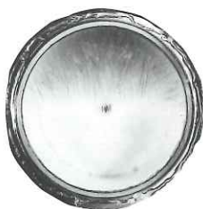
水道管内の水の凍結現象 管上部から樹枝状氷が瞬時に発生し、暫くその状態を維持しつつ、次第に周囲から氷が成長しやがて全体が凍結する。
