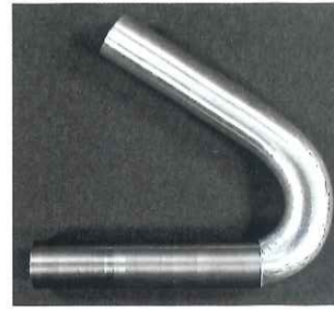
[曲げ図] 強度じん性に優れた機械構造用Ni-Cr-Mo鋼と強度耐食性の良いAl-Mg-Si合金 (A6061) の摩擦圧接継手曲げ試験結果
