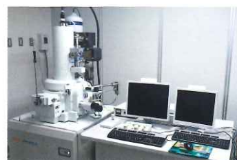
電界放出型SEM装置
