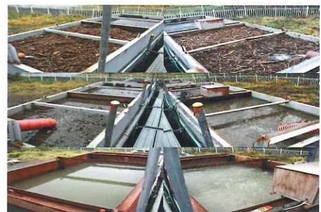
曝気あり(右) および曝気なし(左) 直列水路試験の比較
