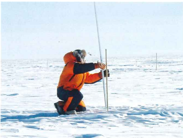
南極ドームふじ基地の-70℃の屋外での雪尺計測（亀田）
