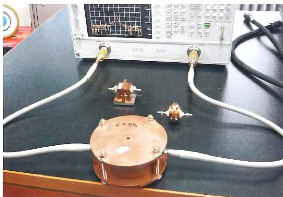
マイクロ波共振器による誘電率測定実験
