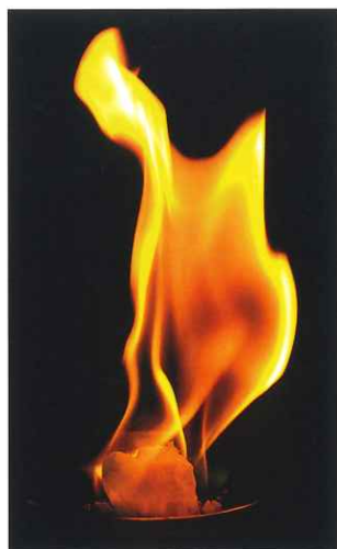
図1 実験室で作成したメタンハイドレートの燃焼
