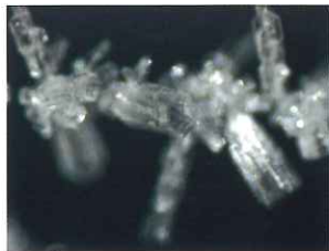
図1 気温 -34.5^{\circ}\text{C} で人工的に生成した低温型雪結晶の顕微鏡画像 (a) と画像処理による3次元情報抽出結果 (b)
