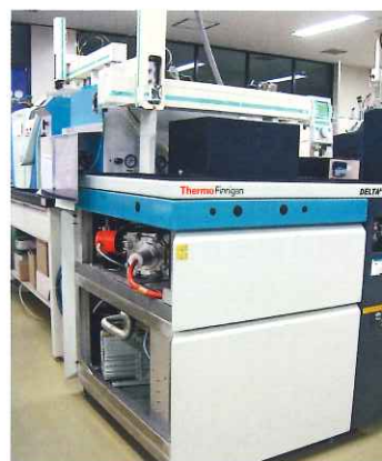
写真3 同位体分析用質量分析装置
