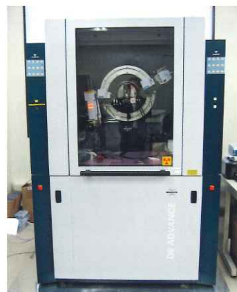
多目的型XRD装置
