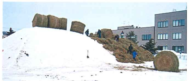
牧草断熱材の貯雪実験
