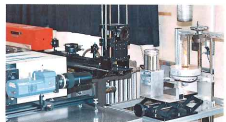
レーザー計測による燃焼診断
