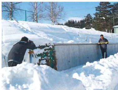
写真2 L型コンクリート擁壁の凍上実験
