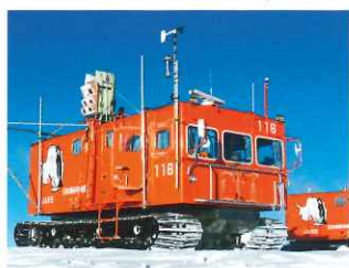
南極大陸を調査する雪上車にはマイクロ波、気象センサーが搭載されている
