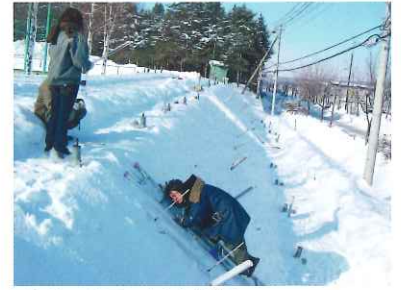
写真3 のり面の凍上変位測定
