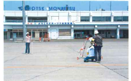
写真3 地盤凍上による施設破損の調査
