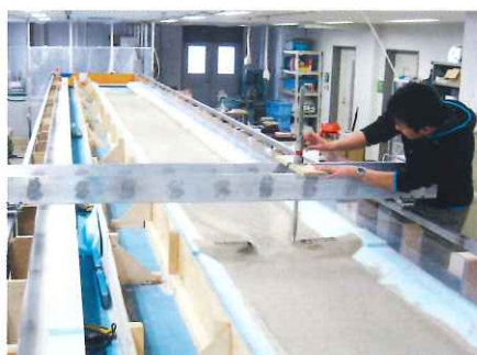
幅広可傾斜式水路
