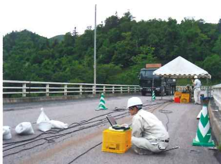
橋の振動測定実験
