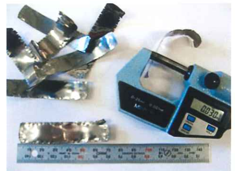
30μm厚まで薄くした水素透過Nb-TiNi合金
