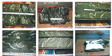
図5 オホーツク海底表層から採取した堆積物コア中に見られるメタンハイドレート（白い部分）。右下隅は、大型サイズのメタンハイドレート（35 cm長）
