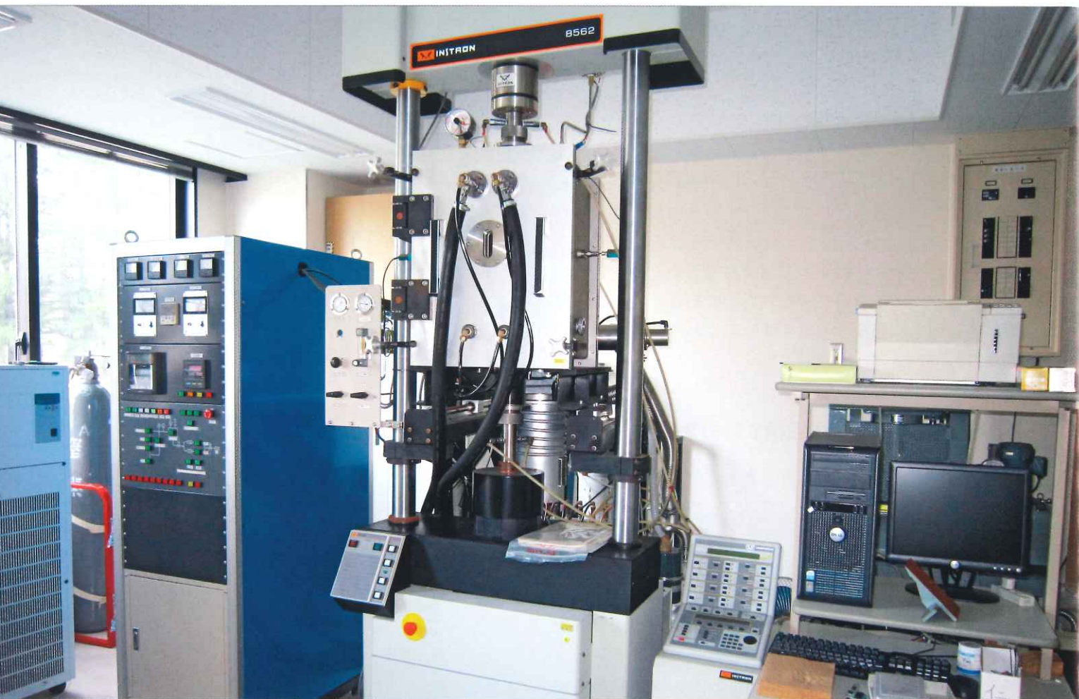
高温水素雰囲気中で水素透過合金の機械的性質を調べるインストロン試験機
