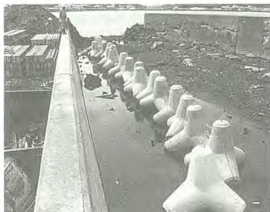
写真2 網走港における暴露実験
