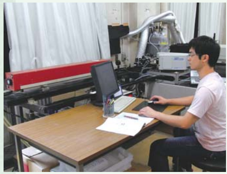
レーザー計測システム レーザー光を火炎やすす粒子に照射し、発生する発光を分析することで各種の濃度分布やすす粒子のナノ構造を調べることができる。
