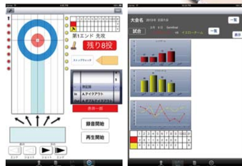
ポータブル戦術支援データベースシステム「ICE」 intelligent Curling Elicitorの略。知的カーリング(情報)抽出の意。カーリング・インフォマティクス構想の第一段階である、「情報の蓄積と解析」を実現することを目指して解析した。ICEはタブレットPC上で稼動し、指先やタッチペンによる直感的な操作によって簡単に試合情報や試合経過を記録することができる。また、記録された情報は即座に解析され、グラフとして表示することができるため、競技中のハーフタイムやタイムアウトにおけるコーチング、試合直後の選手の振り返りやモチベーション維持に役立てることができる。現在、北見工業大学カーリング部と国内トップチームで使用しており、さらなる高機能化を図っている。
