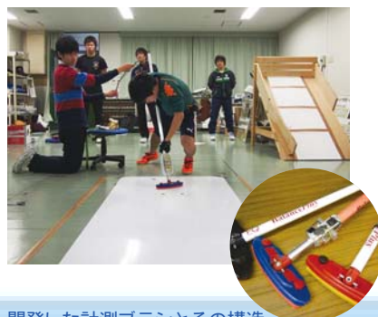
開発した計測ブラシとその構造 カーリングブラシに、シャフトの角度、ヘッドに加わる荷重や加速度を測定するセンサが取り付けられている。また、センサで検出した情報はコンピュータに無線で送信する。プレイへの影響、計測への影響を最小限に留めるため、ブラシに装着する装置も選手が装着する装置も小型・軽量化が図られている。
