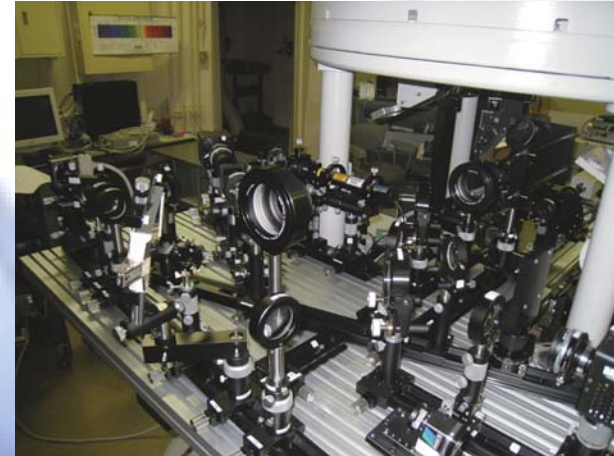
飛騨天文台で開発中の補償光学装置。実際に観測に用いられている装置としては、日本国内では唯一の装置である。海外では、ハワイにある日本のすばる望遠鏡に装備されている。
