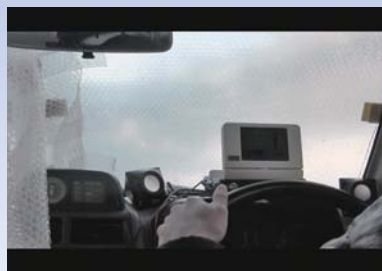
道路中のRFIDタグとアンテナの通信可能範囲の測定
