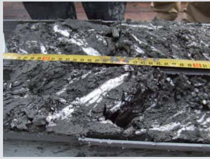
バイカル湖湖底の 表層型メタンハイドレート堆積物 コア 2分割コア中に白く見える部分が メタンハイドレート
