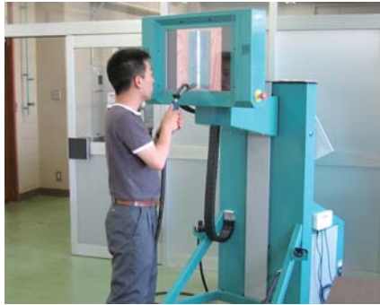
写真11 CSWaveによる模擬溶接（半自動溶接・立向）
