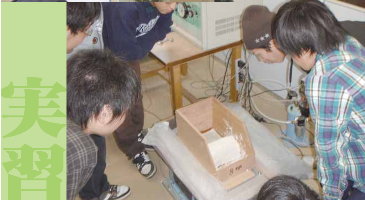
写真上の左) 土材料の混ぜ合わせ 写真上の右) ダム堤体の盛り上げ 写真下) 地震を想定したダム堤体の破壊過程観察
