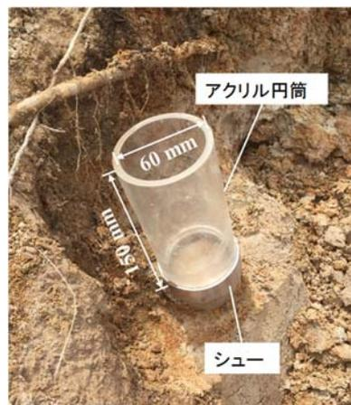
写真 2-1 不攪乱試料の採取
