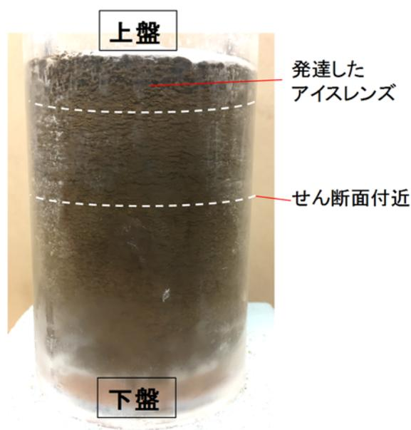
写真 5-3 凍上した根系含有土供試体
