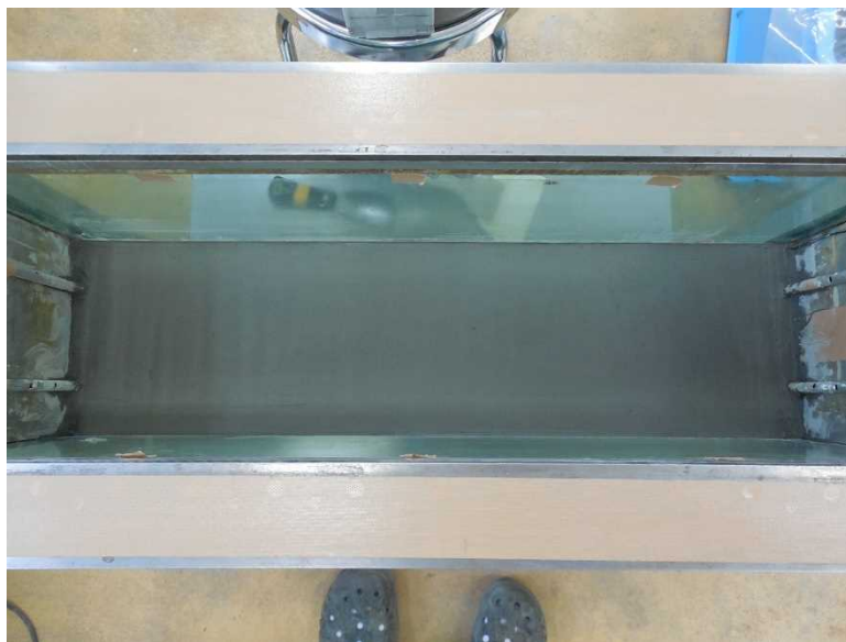
写真 4-9 軟弱地盤（粘土）の完成
