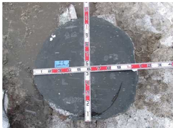
写真 2-32 O-2 コアサンプリング上部・予備サンプリング下部(108×105cm)
