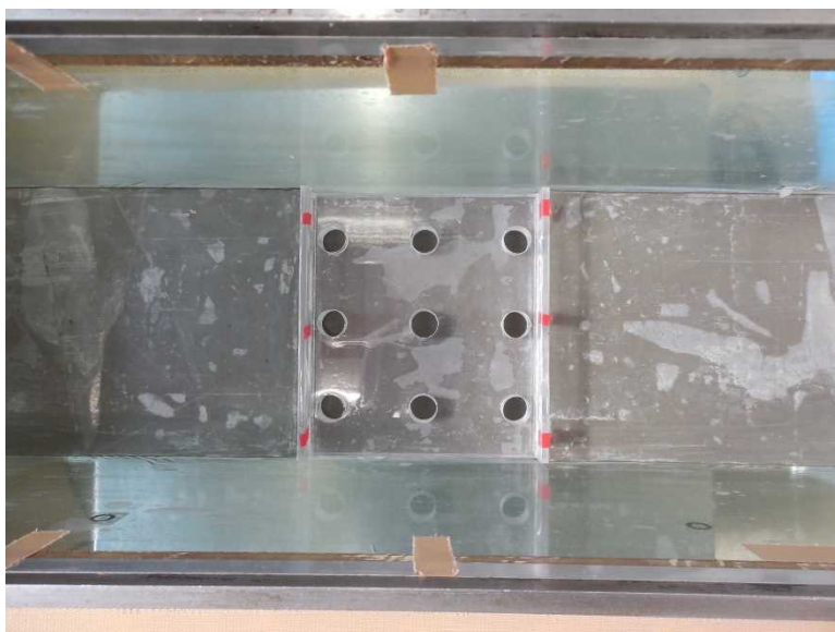
写真 4-19 改良体型枠の設置
