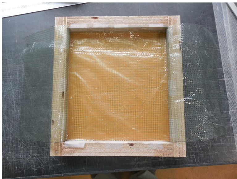
写真 4-25 浅層改良体(グラベル基礎)の型枠
