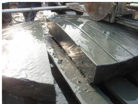
写真 2-25 P-1 矩形サンプリングから 個別試料の採取
