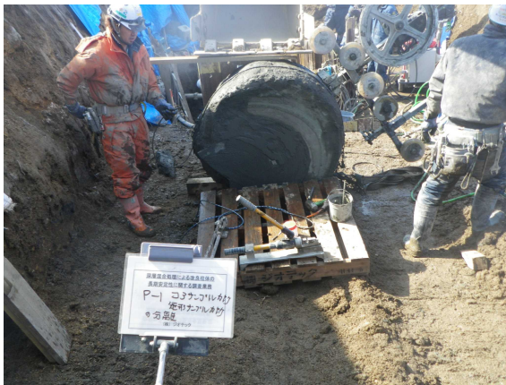
写真 2-20 P-1 コアサンプリングと 矩形サンプリングの分離
