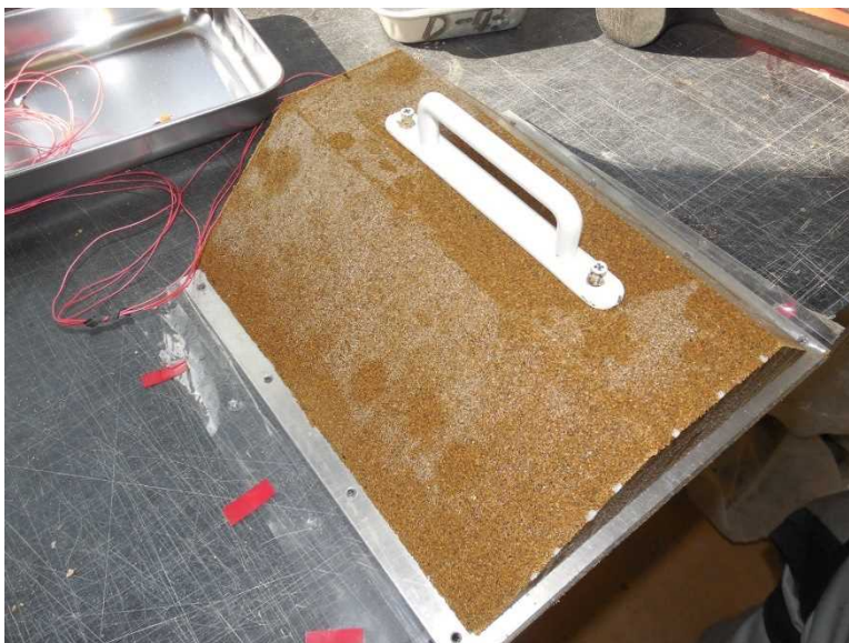
写真 4-15 脱型後の凍結盛土
