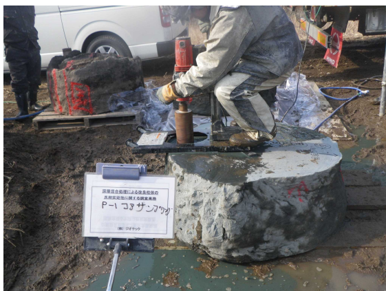
写真 2-22 P-1 コアサンプリングから 一軸圧縮試験試料の採取
