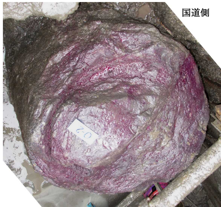
写真 2-10 O-2 フェノールフタレイン溶液散布による中性化の確認
