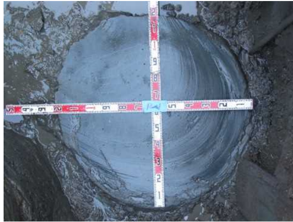
写真 2-27 P-1 矩形サンプリング下部(114×119cm)切出し面で計測
