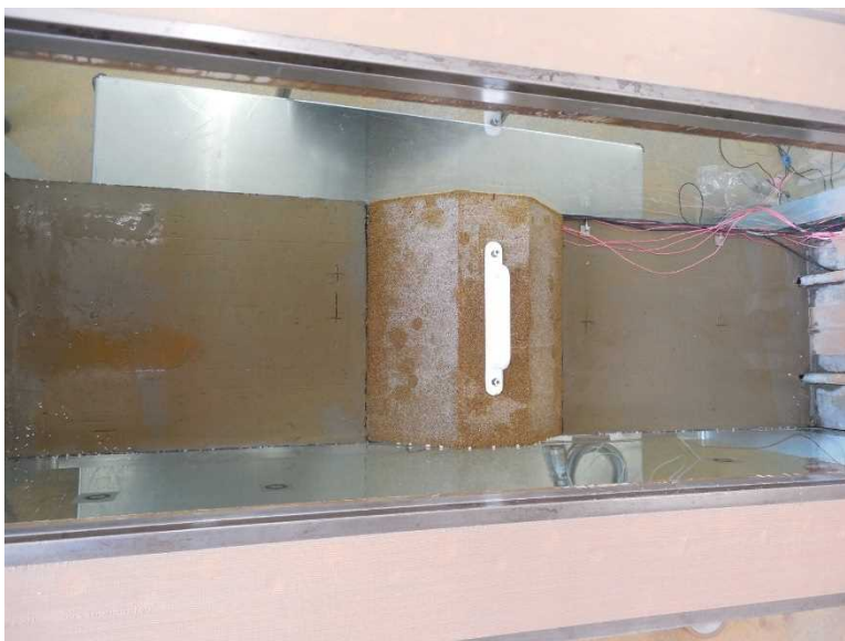
写真 4-16 軟弱地盤上に凍結盛土を設置
