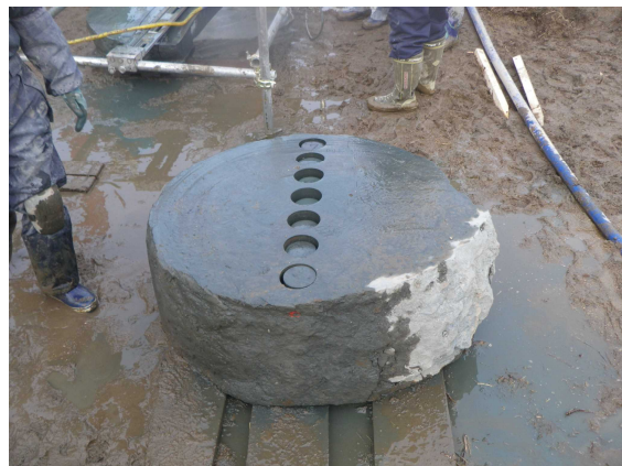
写真 2-23 P-1 一軸圧縮試験試料 採取完了
