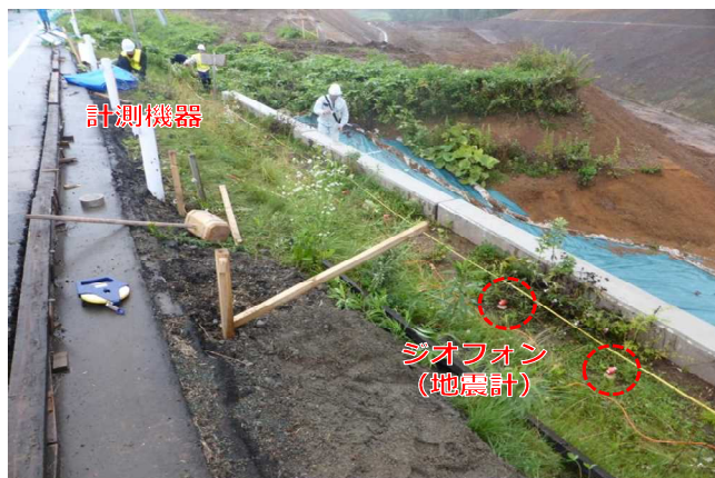
写真 5-3 当該現場における表面波探査の実施状況（再構築前）
