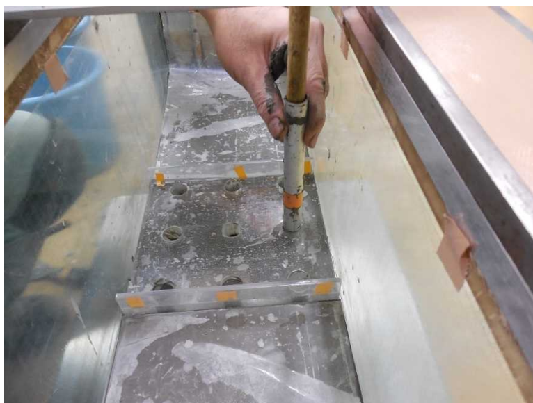
写真 4-23 掘削孔へセメントスラリーを注入
