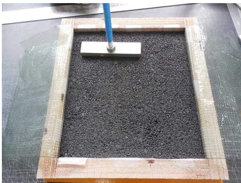
写真 4-26 碎石の締め固め
