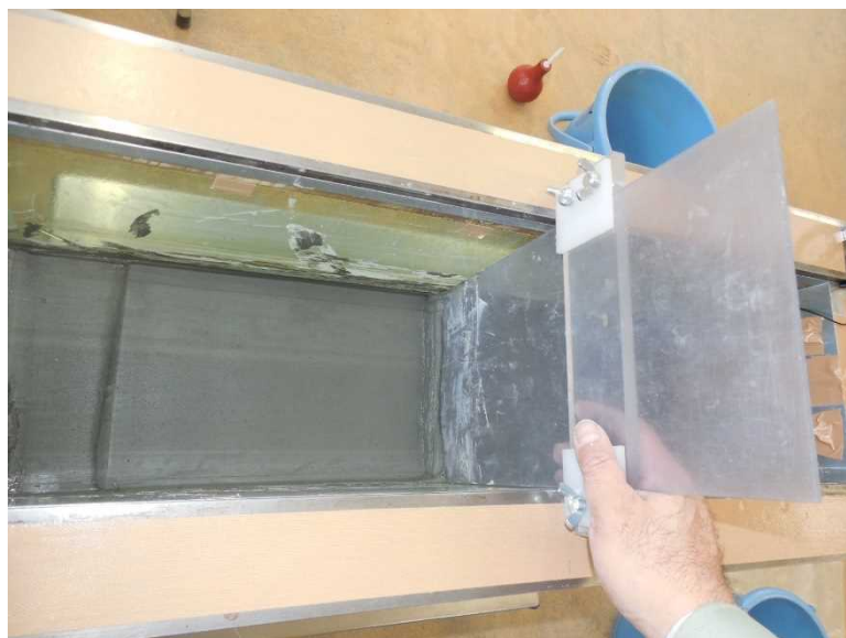
写真 4-8 所定の高さまで粘土表層部をカット
