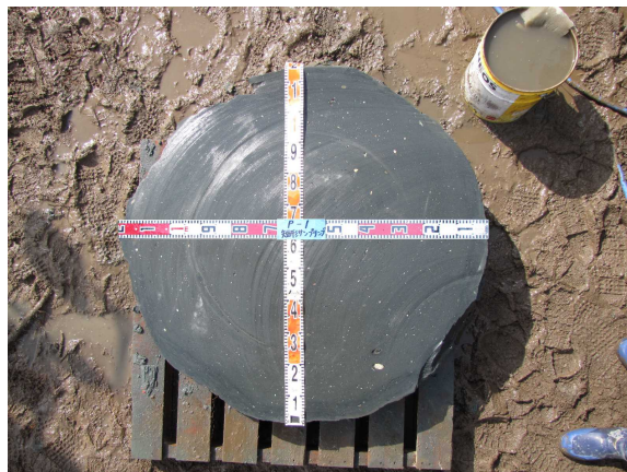
写真 2-28 P-1 矩形サンプリング上部・コアサンプリング下部(114.5×117cm)
