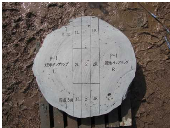
写真 2-24 P-1 矩形サンプリングから 針貫入試験試料のマーキング
