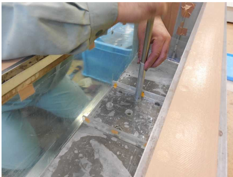
写真 4-22 内管の挿入状況
