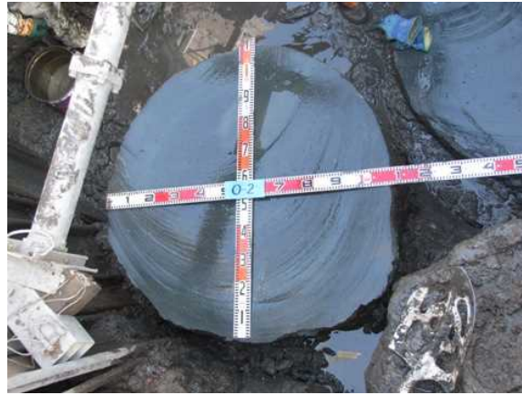
写真 2-30 O-2 矩形サンプリング下部(106×107cm) 切出し面で計測
