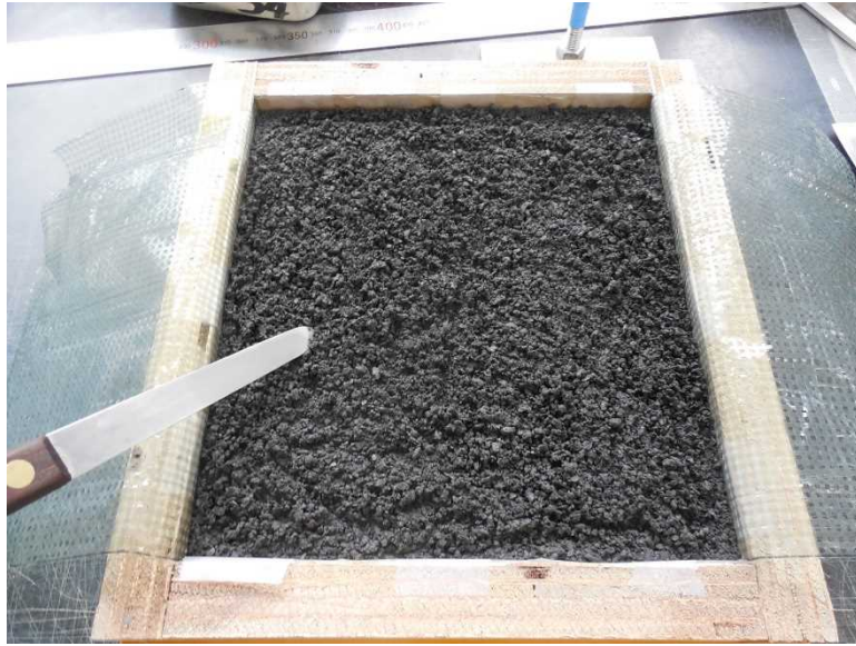
写真 4-27 碎石表面の目粗し
