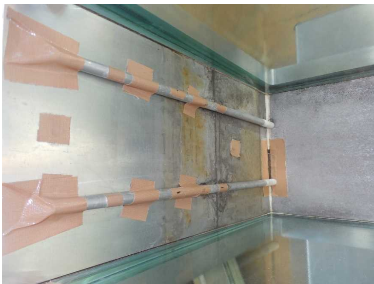
写真 4-2 排水パイプの設置
