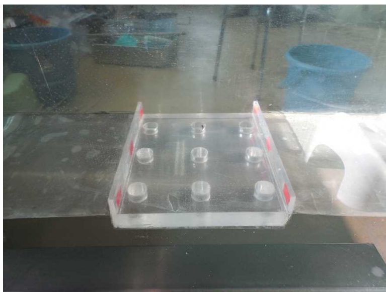
写真 4-18 改良体型枠周辺部へのビニールの貼り付け
