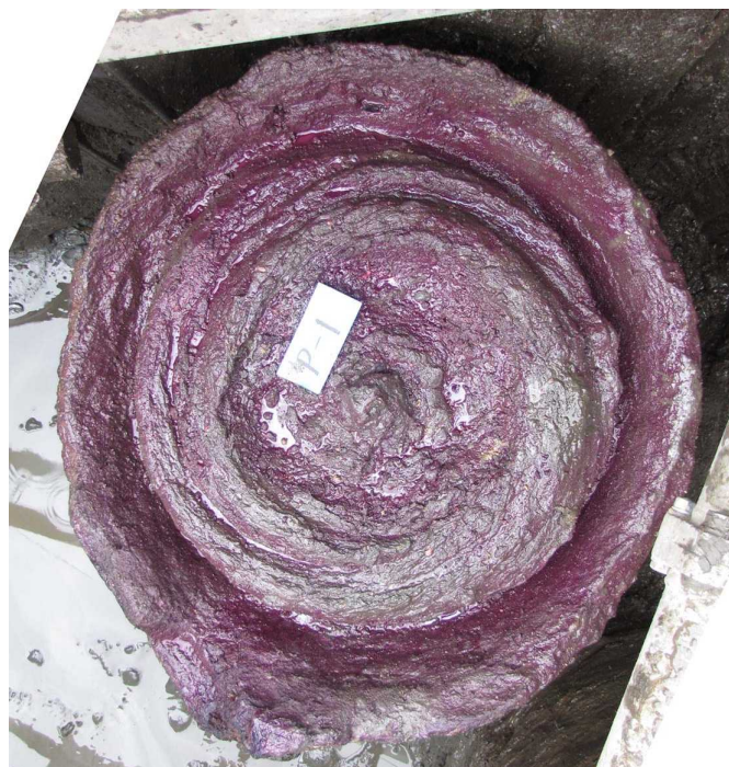
写真 2-8 P-1 フェノールフタレイン溶液散布による中性化の確認
