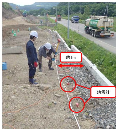
写真 5-5 表面波探査の実施状況
