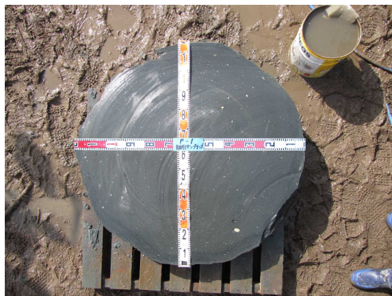
写真 2-29 P-1 コアサンプリング上部・予備サンプリング下部(107×108cm)
