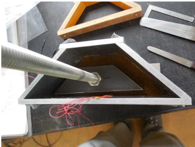
写真 4-12 山砂の締固め
