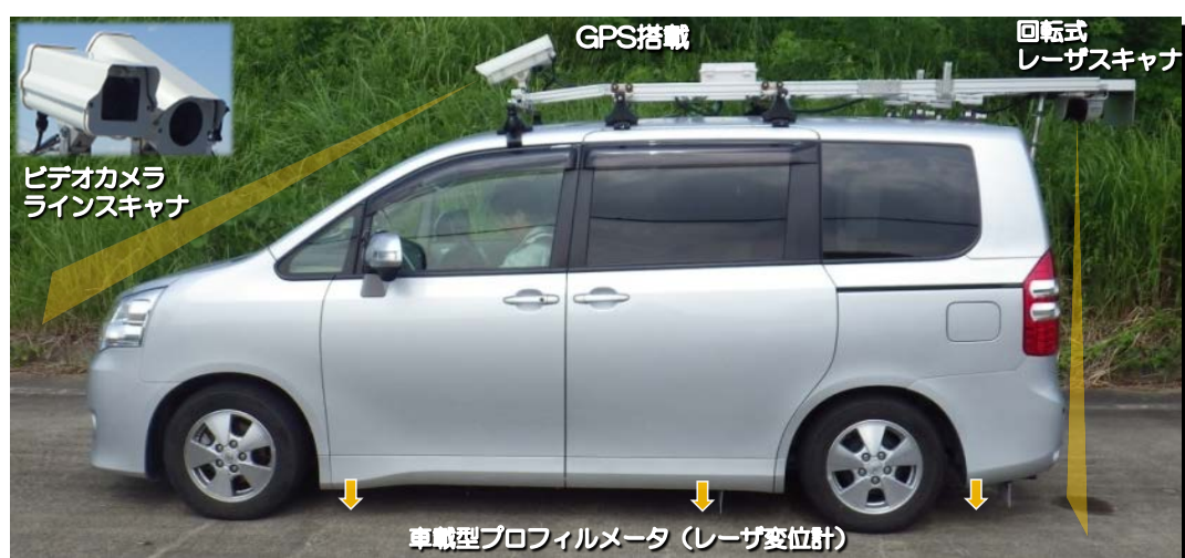
図-2.2 簡易型路面性状測定車による多機能路面性状評価システム
