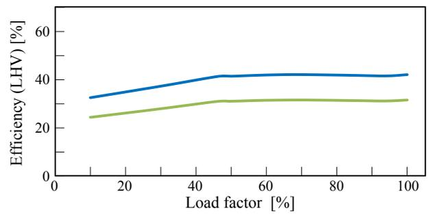
(d) Methanol reformed gas-supplied PEFC
