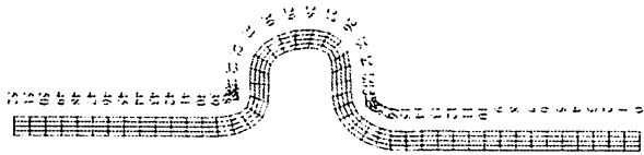
図-14 標津川蛇行復元試験地を簡略化した格子モデル
