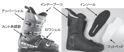
図1 スキーブーツの一般的構成
