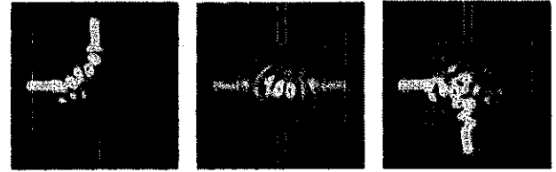
(a) \lambda_1 = 1.31 \mu\text{m} (b) \lambda_2 = 1.49 \mu\text{m} (c) \lambda_3 = 1.55 \mu\text{m} 図4 最適化構造の伝搬波形 (単純分岐初期構造)
