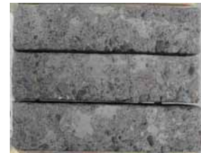
写真2 劣化供試体 (凍結融解 300 サイクル終了時)
