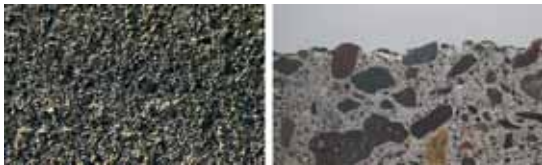
写真5 水中部劣化状況（左：表面，右：側面）
