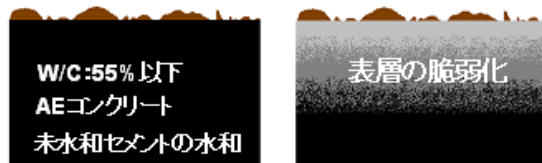
図3 表面劣化コンクリートの概念図
