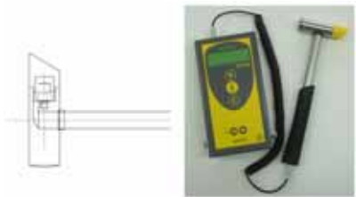
写真1 ハンマー（機械インピーダンス法）
