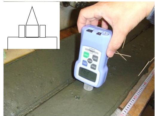
写真-2 コーン貫入試験
