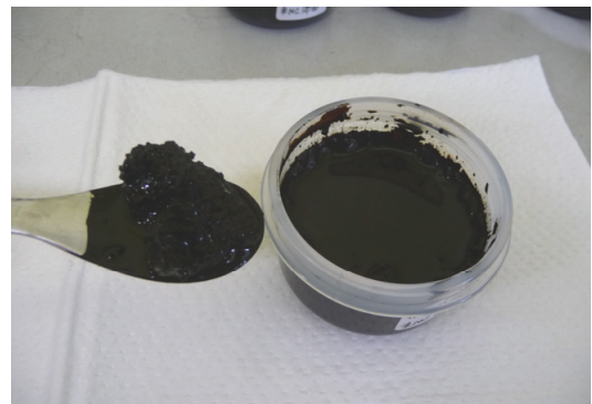
図-1 カチオン系乳剤への添加時に生じた凝集塊
