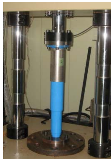
写真-5 ダンパー設置状況
