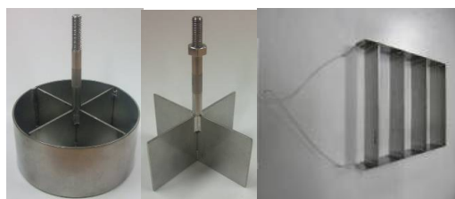
図-1 測定機器 リング付きベーン (左) 従来型ベーン (中) シアフレーム (右)
