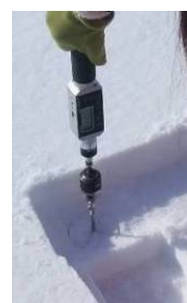
図-2 リング付きベーン試験器による測定
