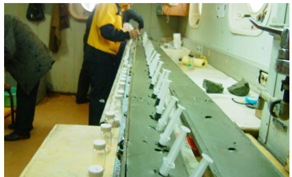
写真-4 含水比試験用の試料採取
