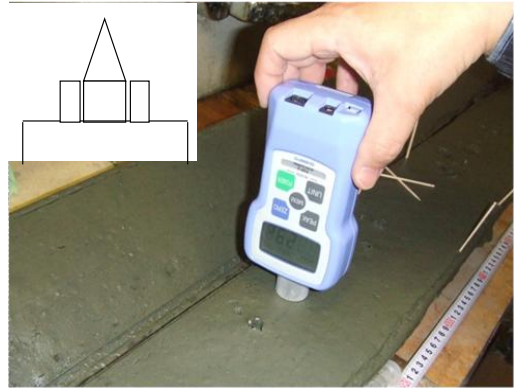
写真-3 コーン貫入試験
