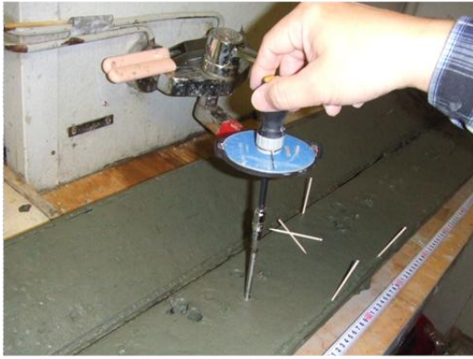
写真-2 ベーンせん断試験
