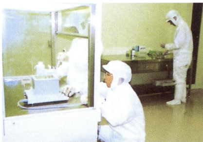
クリーンルーム クラス1000、室温 23 \pm 1 ℃、湿度50~60%にコントロールされています。
