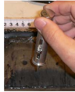
写真2 コーン貫入試験
