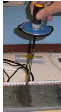
写真1 ベーンせん断試験
