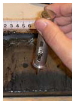
写真2 コーン貫入抵抗の測定
