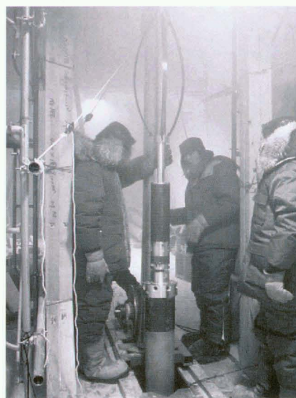
図5 第3リーマー(大口径アンチトルクを使用, 4月18日)
