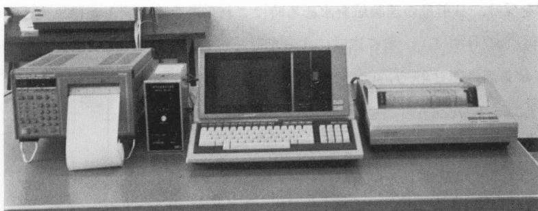
写真-2 計測システムの外観 (A/D コンバーター及びマイクロコンピューター MZ-2000 とその周辺機器)
