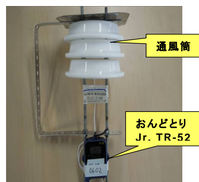
図-1 自然通風筒付き温度計
