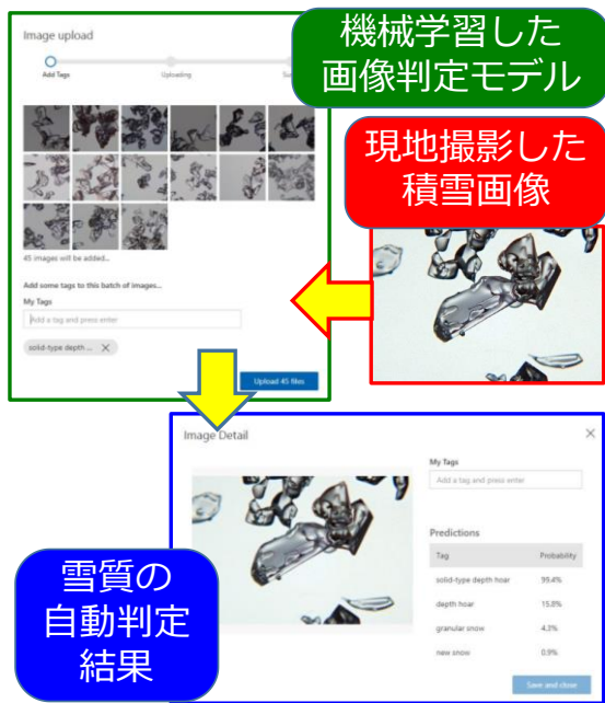
図2 機械学習による雪質判定の流れ (Microsoft Azure の Custom Vision)
