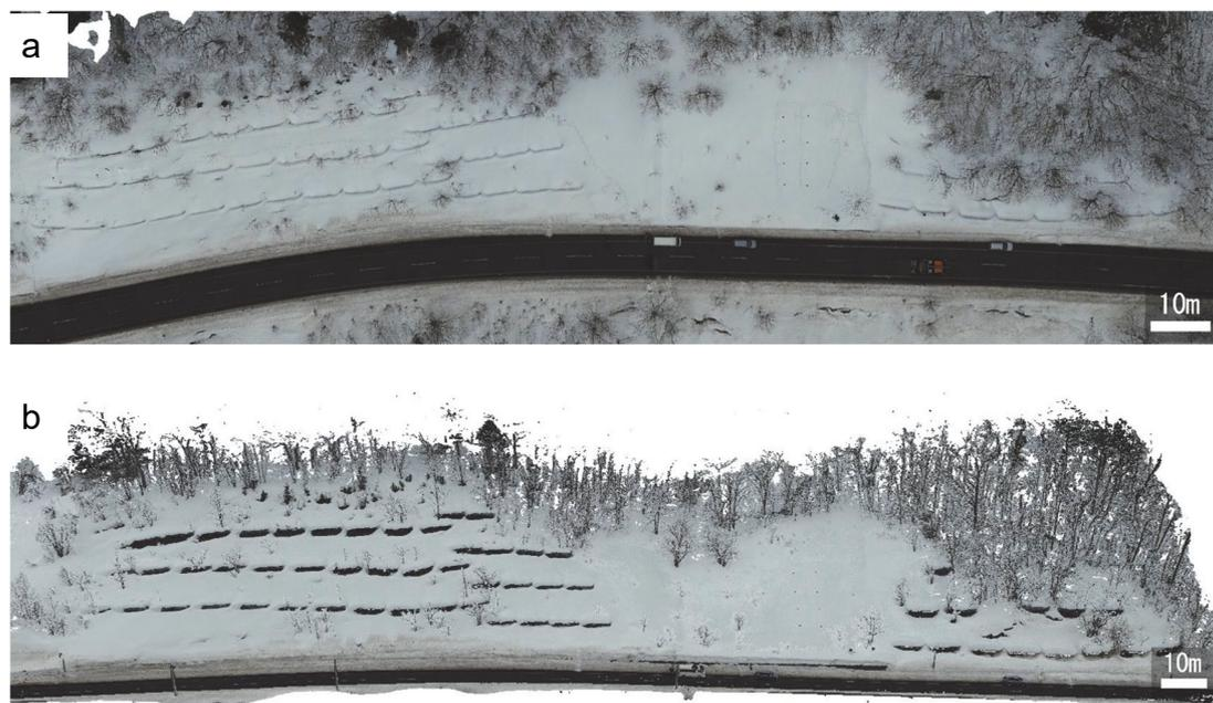
図 6.11 UAV-SfM 計測による点群の欠損事例（黒い部分は点群が欠損）. (a) UAV-SfM によるオルソ画像, (b) UAV-SfM による点群.
