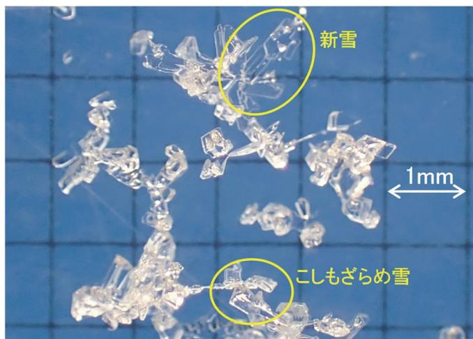
図 5.6 積雪表面の雪結晶（新雪，こしもざらめ雪の混合型）。
