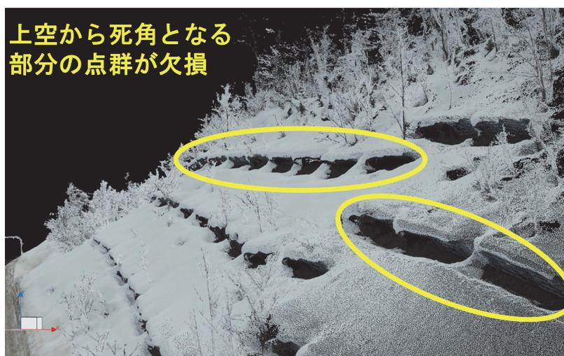
図 6.1 点群が欠損した UAV-SfM 計測の事例 (黒が欠損).
