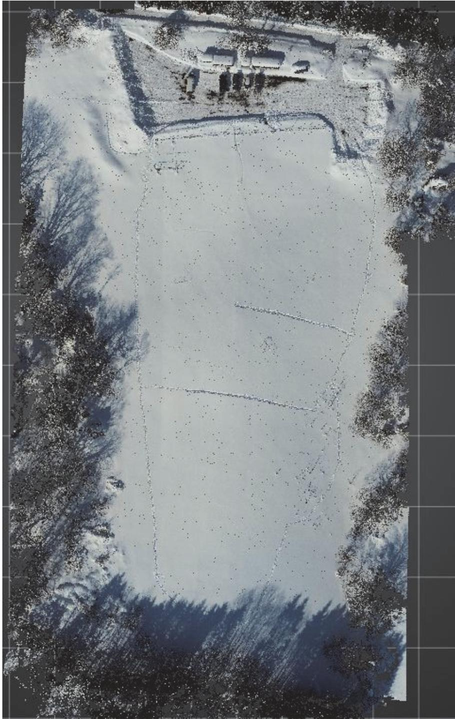
図 5.8 RTK 搭載型 UAV による雪面の点群の例 (2022.2.10 撮影).
