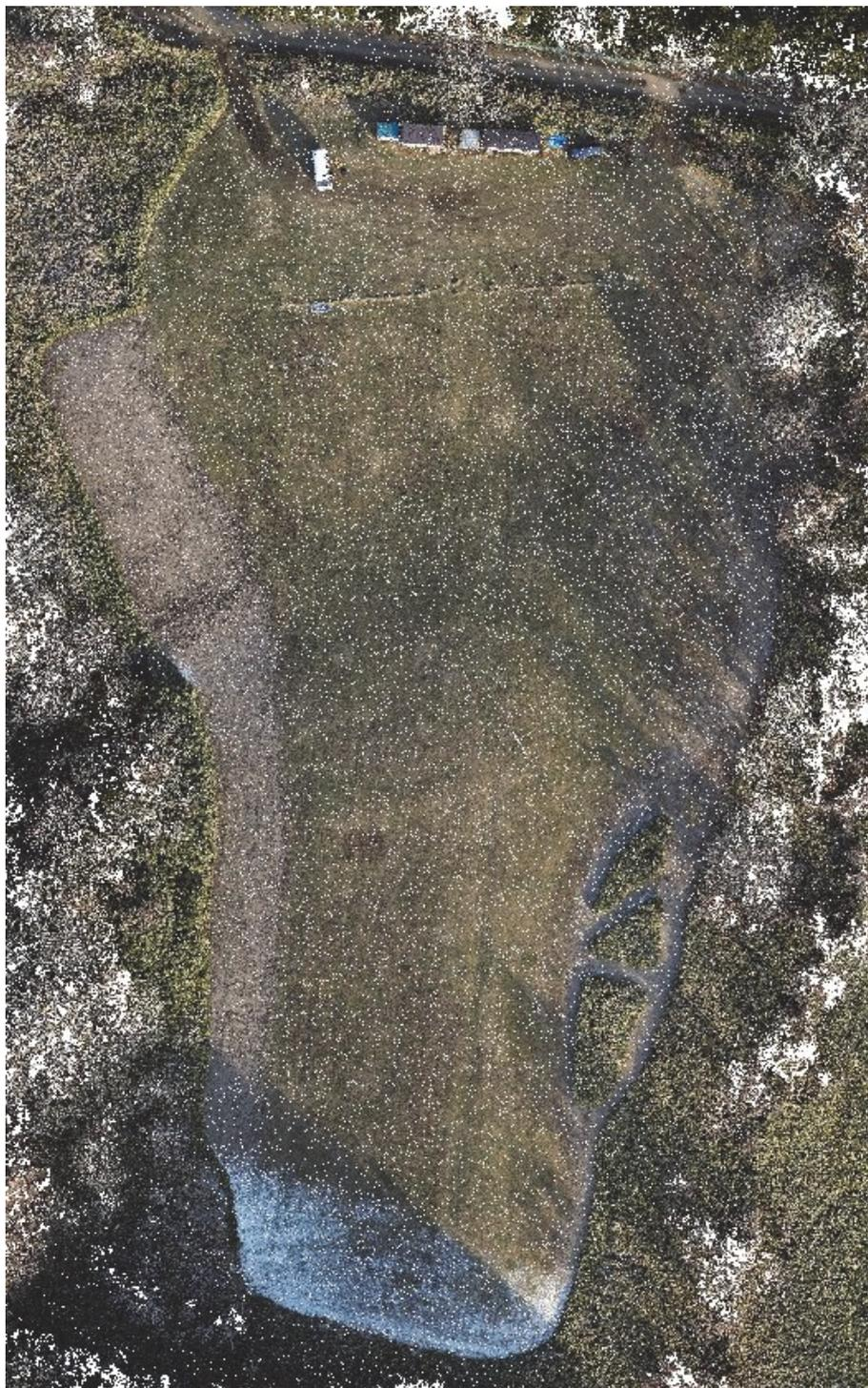
図 5.7 RTK 搭載型 UAV による地表面の点群の例 (2021.12.16 撮影).
