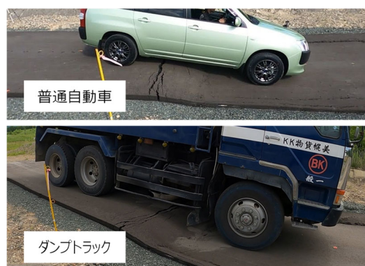
写真-6 車両走行試験の様子（ジオセル3層）
