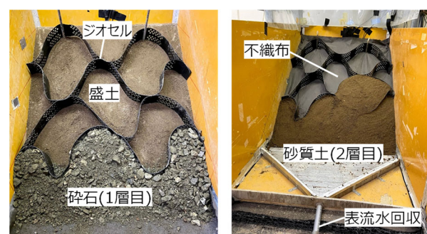
写真-2 模型盛土の構築過程
