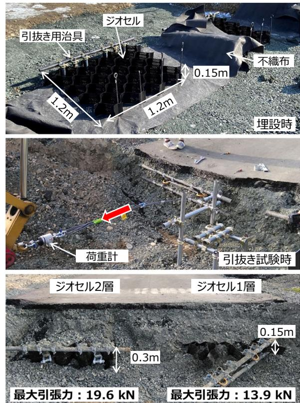
写真-5 実大舗装路で実施した引抜き試験の様子
