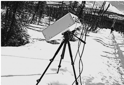
図 1 本研究で使用した可搬型マイクロ波放射計 (MMRS2). 写真はポーカーフラット観測サイトで積雪観測中の MMRS2 の様子.
