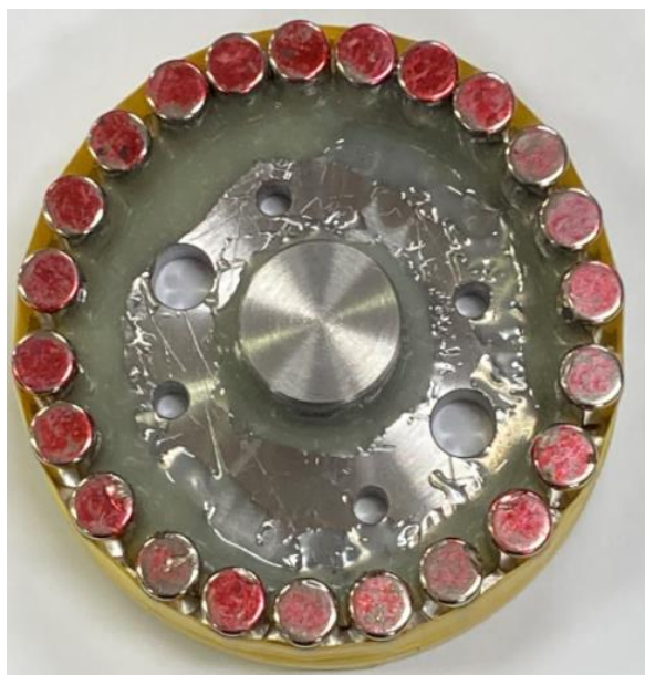
図 3.16 マグネトロンスパッタ装置のマグネット部分
