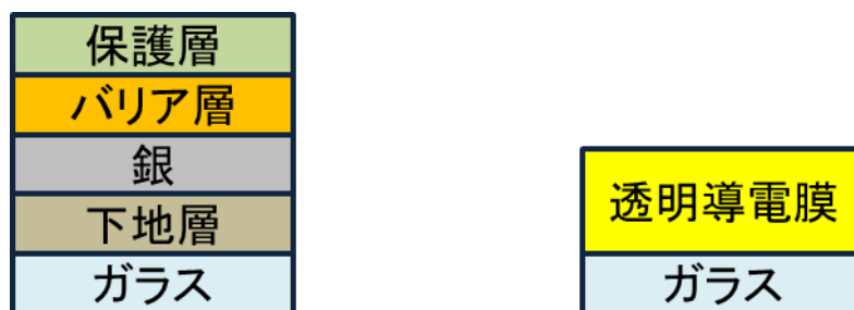
図 1.11 Low-E 膜の構成例
