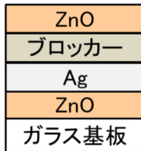
図2.1 一般的なAg系Low-E多層膜構成
