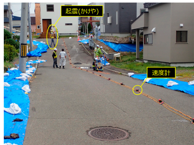
図-2 表面波探査の実施状況の例
