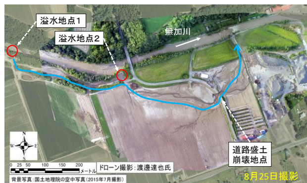
図-23 広里地区の溢水による道路盛土の崩壊と農地の流出
