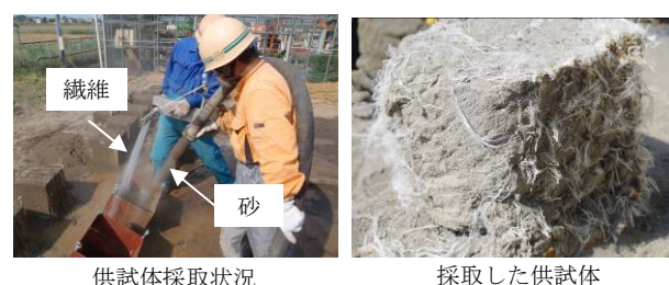
写真－１ 屋外作製供試体の採取状況と採取した供試体
