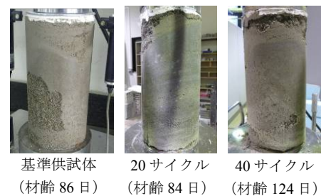
写真－４ 基準供試体と凍結融解供試体
