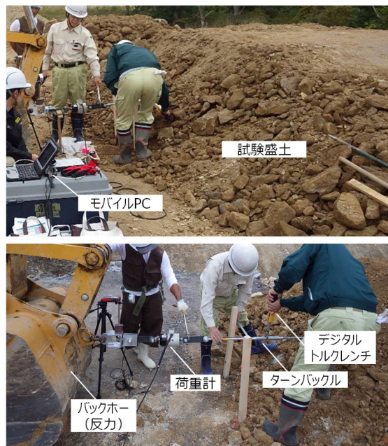
写真-2 屋外模型試験の様子
