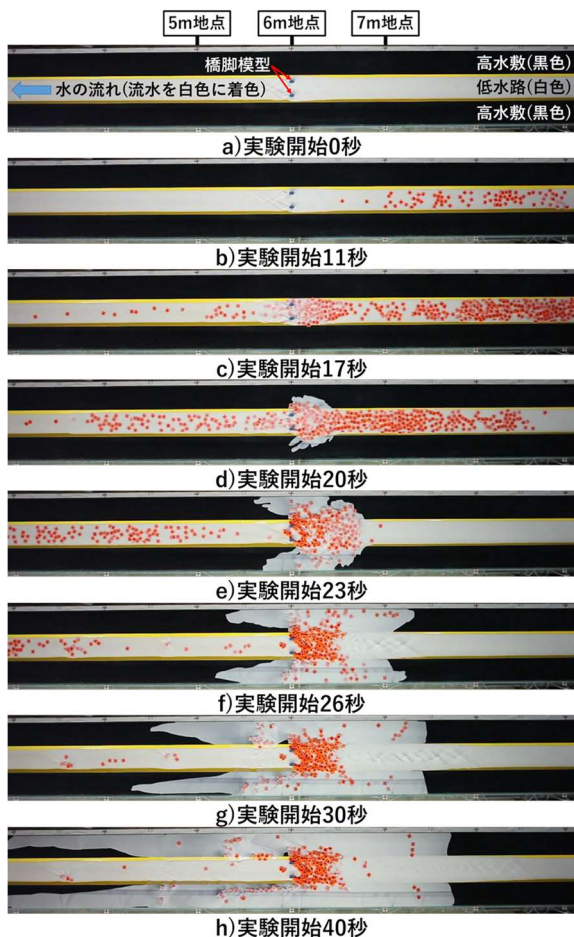
図-4 アイスジャム実験状況 (ポリプロピレン, Case1)
