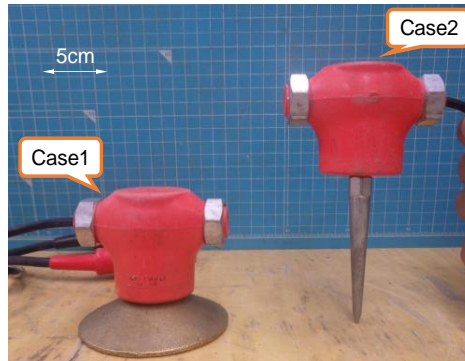
図-6 地震計下部の金属製土台
