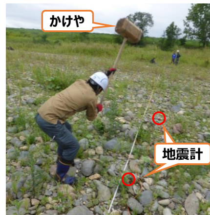
図-3 陸域（礫河原）での表面波探査の実施状況
