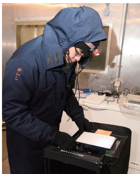
写真5 低温実験室では、できるだけ自然雪に近い人工雪を作り、さまざまな雪質の条件下で埋込型センサーの試作機を使った実験を進めている。
