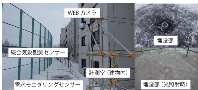
写真4 屋外用の路面埋込型センサーの埋設の様子。
