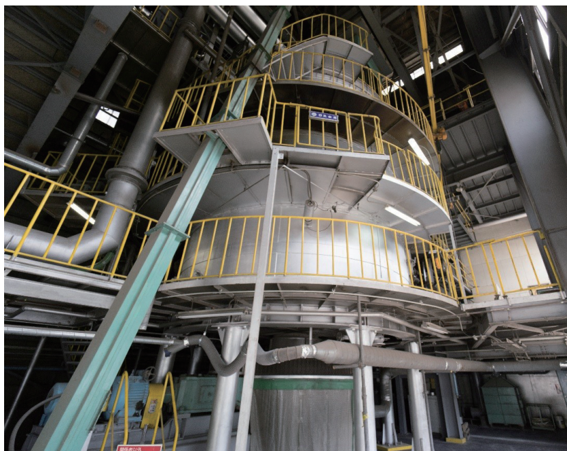
水銀スラッジを焙焼して 蒸気水銀を回収する多段 式焙焼炉。
