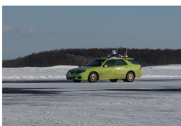
写真 2 路面の滑りやすさを計測する摩擦抵抗測定車。稼働時には、空港を閉鎖しなければならない。（写真提供：JAXA）
