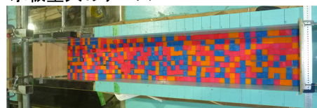
図-2 水路内における氷板模型の設置状況
