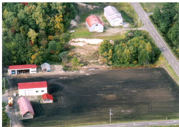
図13 2003年十勝沖地震時の航空調査によって視認した盛土地盤の崩壊箇所
