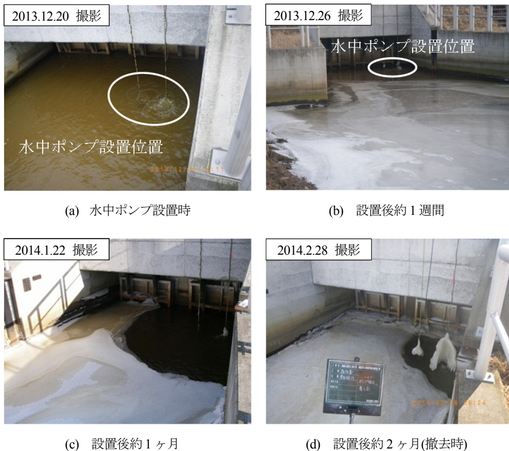
図－７ 水中ポンプによる結氷制御対策実施状況
