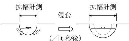
b) 細砂を含む破堤の経過と特徴・拡幅計測位置
