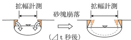
図-9 横断側線における破堤の経過と特徴, 及び拡幅計測位置
